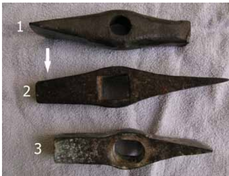
Figura 5. Tres tipus de martells de tall.
