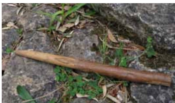
Figura 3. Inicialment, es talla amb la punta rodona i amb la feina d'omplir les juntes s'esmola a causa del fregament amb les pedres.
