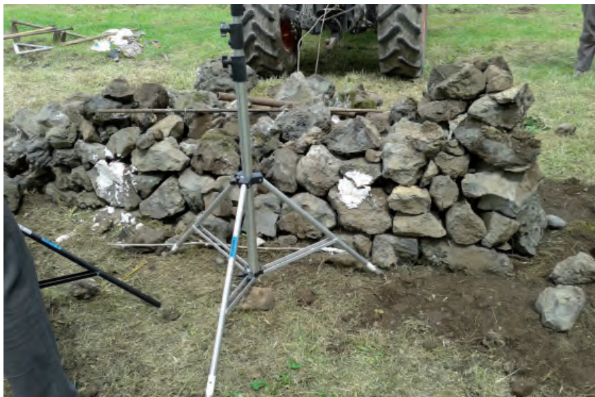
Paret de dos paraments després de l'assaig destructiu (C. Blasco)
