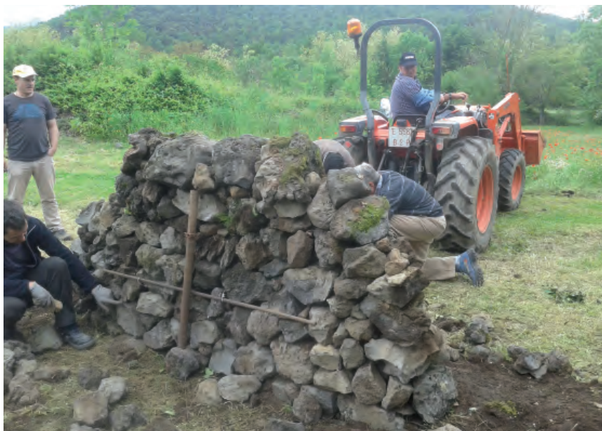
Paret de dos paraments abans de l'assaig destructiu (C. Blasco)
