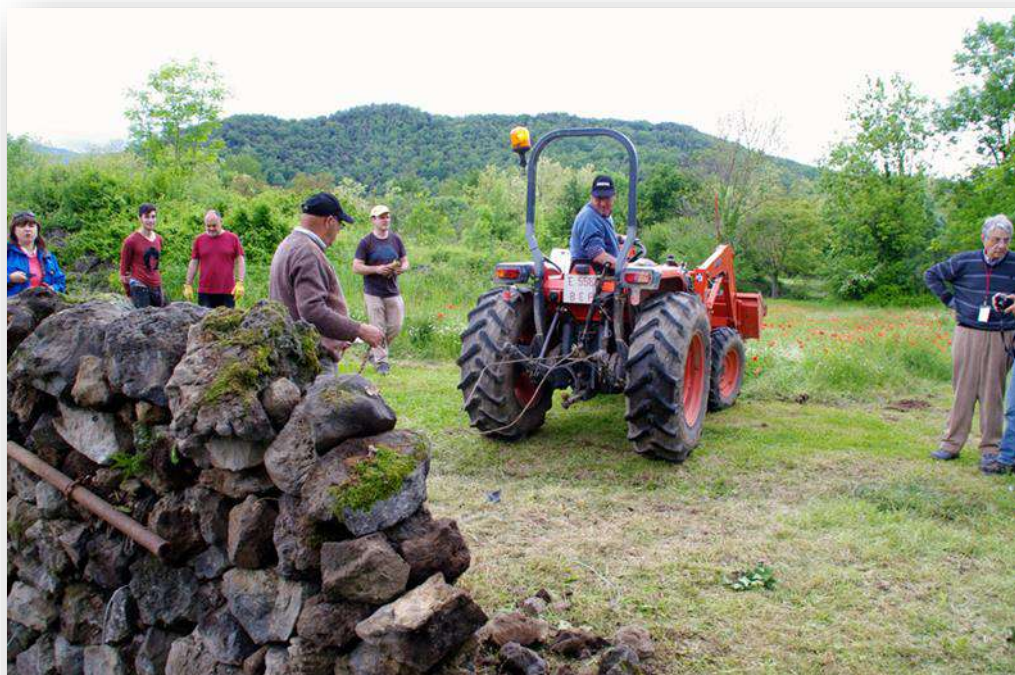
Taller per mesurar la resistència d'una paret de pedra seca
