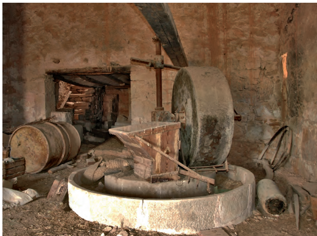
■ Molí de l'Ignasi del Bep de Canut. Molí d'oli que funcionava a la manera tradicional (molí de sang). Estava dividit en dos espais diferenciats: el destinat a la mòlta de les olives i l'altre on es feia l'extracció de l'oli. En el primer hi havia dues moles que funcionaven per tracció animal. El sistema emprat per a la extracció de l'oli era la premsa de lliura (també anomenada seixantè). Aquest molí disposava de dues premses, una de les quals encara es conserva in situ en bon estat.
