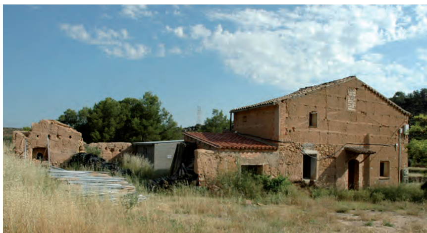
■ Mas del Janet. Edifici rural construït amb parets de tàpia on hi vivia permanentment una família que tenia cura de la finca. Disposava de corral adjunt per als animals i d'un forn de pa fet amb toves.
